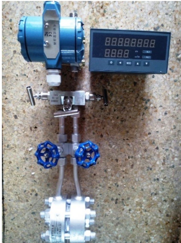
下图为 一体化孔板流量计 配套流量积算仪
